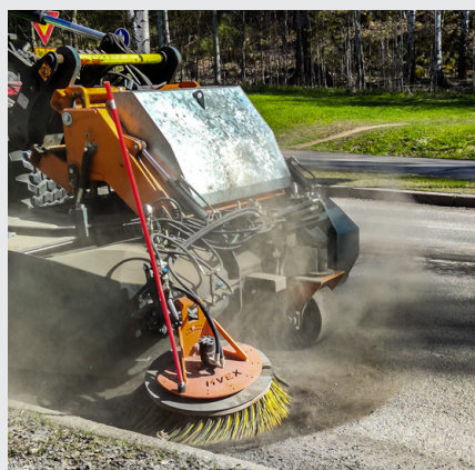
Hydraulinen sivuharja lisää työlevyettä 450 mm per harja.
